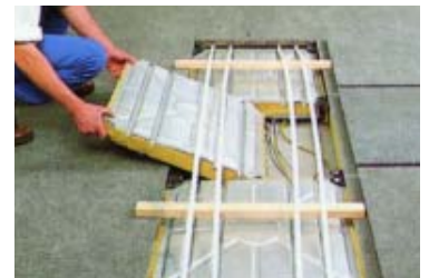
Beim System 4 K von Mero/Velta werden unter die Bodenplatten Wärme-dämmkassetten eingehängt. Die Heizrohre können für Revisionen oder Nachrüstungen zum Öffnen des Bodens ausgeclipst werden.
