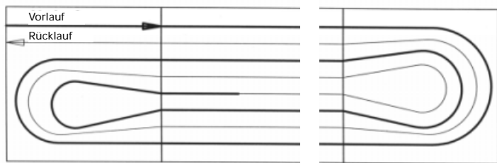
Über die Wärmeleitbleche werden bis zu 20 Bodenplatten in Reihe zu einem Heizkreislauf zusammengefasst.
